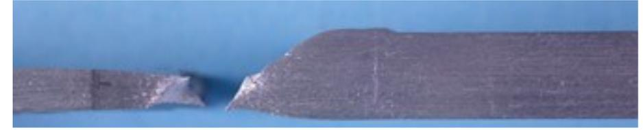
片側溶接試験片の破断は溶接ルート
