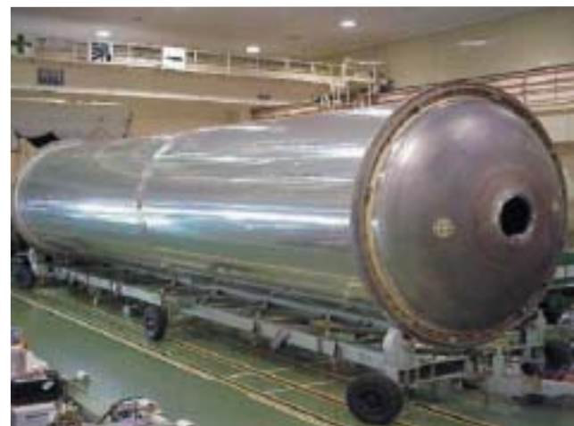
機体の大部分を占める燃料タンクは、ロケットの上昇時にかかる圧縮荷重とタンク内加圧を受けるため、高い強度が要求される。
