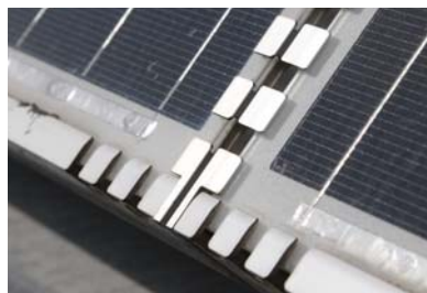
アルミフレームに凹加工を施すことによって、モジュール表面にたまる汚れを雨水などで排出できるようにしている。
