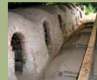
催事では登り窯が使用される。燃料には赤松の薪が用いられる。
