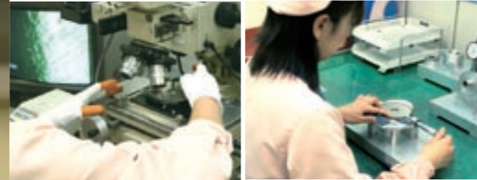
ディスク材の表面キズ検査(左)外径検査(右)。厳しい品質チェック体制を維持するには、女性社員のパワーが欠かせないとか。
