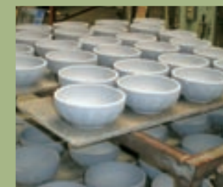
窯に入れる時は、焼きムラなどが起きないように並べ順を考えていく。
