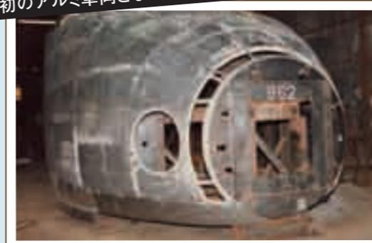
初代東海道・山陽新幹線0系車両の次に登場したのが、東北・上越新幹線200系車両である。200系車両は、豪雪地を高速走行するため耐寒耐雪対策を備える必要があったが、従来のスチール車両では重量がかさむ。そこで採用されたのが軽量なアルミニウム。以来、ほとんどの新幹線車両にアルミニウムが使用されるようになった。ちなみに0系の次が200系なのは、当時、東海道・山陽新幹線は奇数、東北・上越新幹線は偶数と、系列番号の百の位が振り分けられていたことによる。
