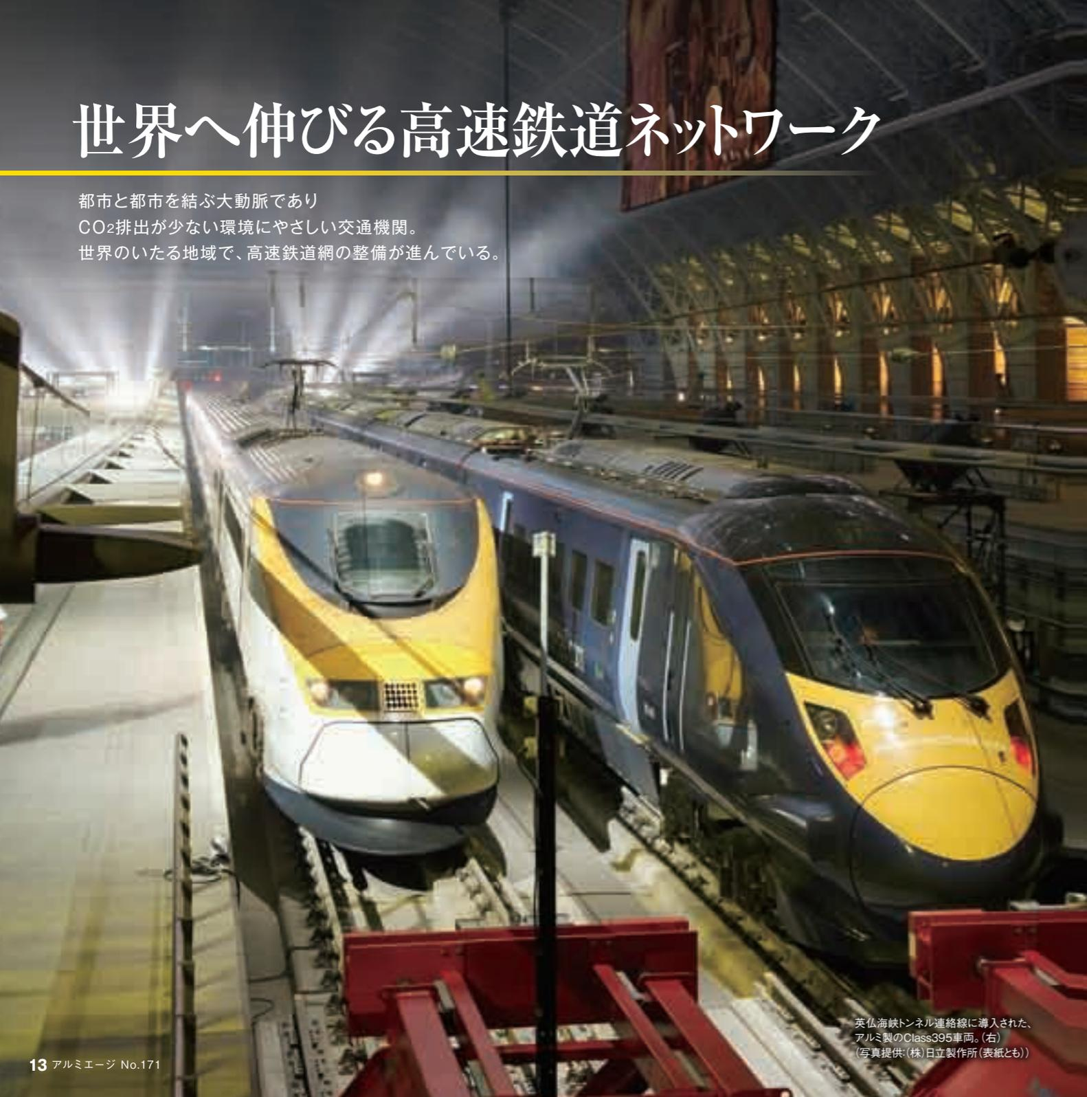
英仏海峡トンネル連絡線に導入された、アルミ製のClass395車両。(右)
