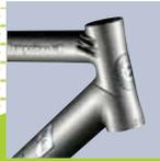
極太肉薄アルミダウンチューブを採用したフレーム
