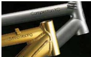
熱による強固な接合のTIG溶接(手前)と、特殊樹脂で高強度結合のミヤタ特許・APA接着工法のヘッドチューブ部分
