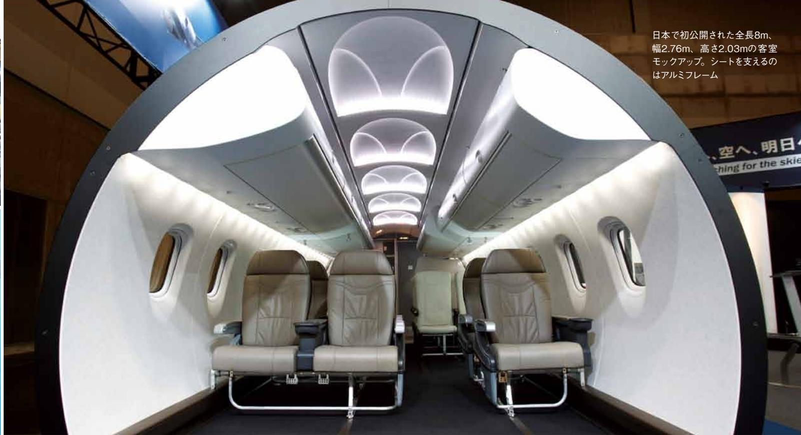
日本で初公開された全長8m、幅2.76m、高さ2.03mの客室モックアップ。シートを支えるのはアルミフレーム
