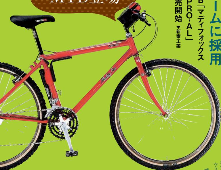
※7000系アルミ合金=主にアルミニウムに亜鉛、マグネシウム、銅を添加した合金で、アルミ合金の中でも高い強度をもつ構造用合金、代表的な合金に、超々ジュラルミンと呼ばれる7075合金がある。航空機、スポーツ用品、鉄道車輛などに使用される
