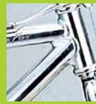
※6061アルミ合金=アルミニウムにマグネシウム、シリコンを添加した6000系アルミ合金の代表的な合金のひとつ。6061合金は、微量の銅を添加し構造用鋼材に相当する耐力をもつ。船舶、鉄道車輛、建築構造物などに使用される
