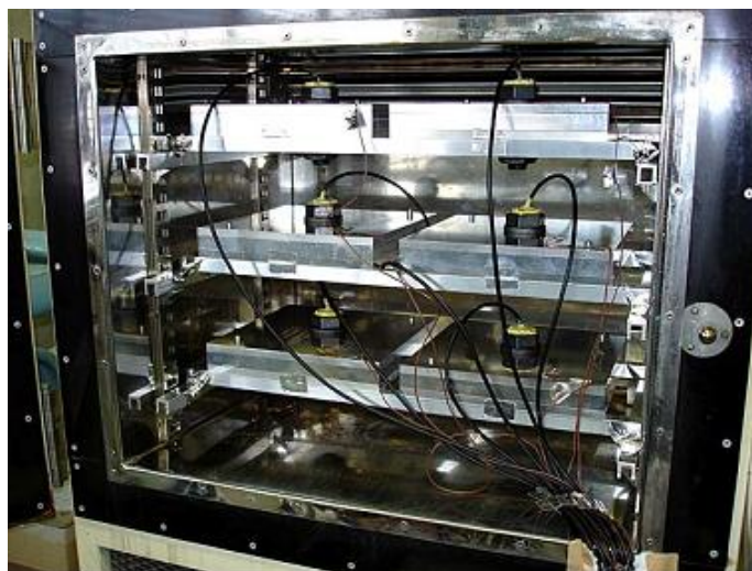
図-3.3 恒温槽に設置された試験体
