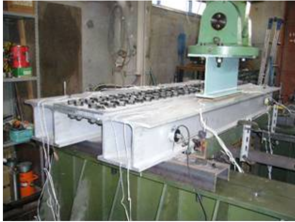
図 10 側辺現場継手の疲労試験
