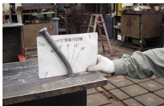
図13 頭付きスタッド溶接部の曲げ試験
