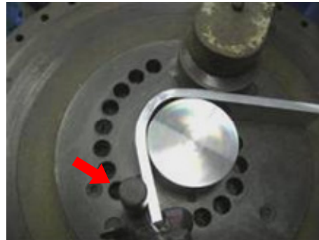
(b) 試験片と曲げ治具の間の隙間
