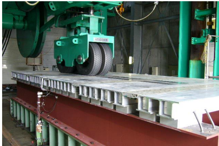
図-1.3 道路橋用アルミニウム床版のトラックタイヤ移動載荷疲労試験
