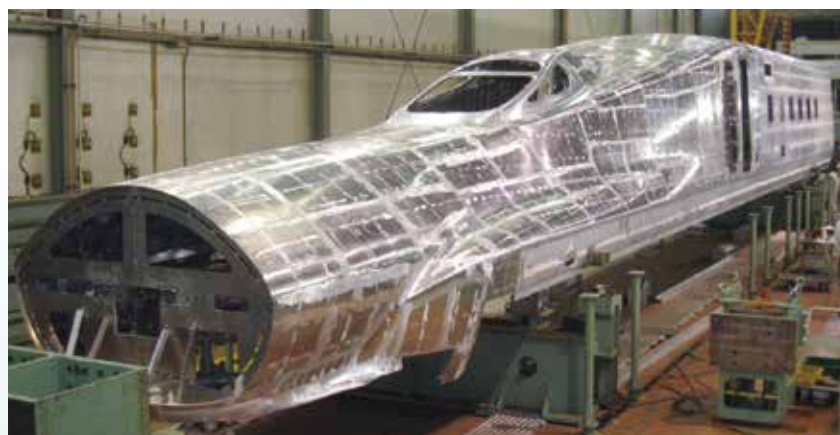
ロングノーズのシャープな流線形が特徴のオールアルミ車両。写真はE5系の量産先行車両
