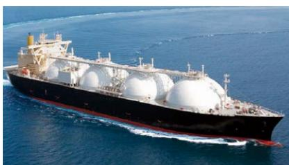
クリーンなエネルギーであるLNG（液化天然ガス）はマイナス162度なので、低温に強いアルミタンク（丸い部分）に入れられる。
