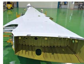
主翼は、大きいカーブのある形をしているため、軽くて作りやすいアルミニウムで作られている。
