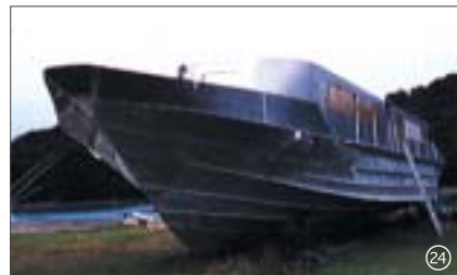
アルミ船には厚さ4～10mm程度の厚板が多く使われる
