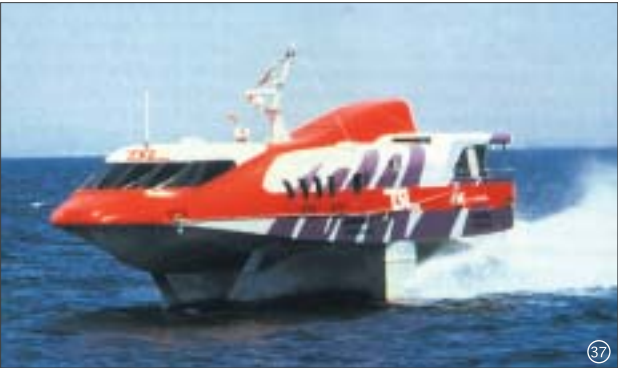
テクノスーパーライナー「疾風」は水中翼を持つ揚力式複合支持船型で、船体にアルミ中空押出材やハニカムパネルが使われた
