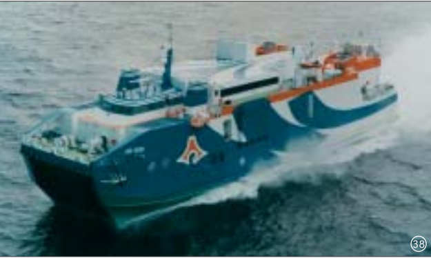
テクノスーパーライナー「疾風」は水中翼を持つ揚力式複合支持船型で、船体にアルミ中空押出材やハニカムパネルが使われた
