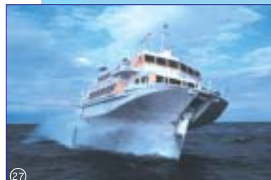
『つばさ』新潟ー両津(佐渡) 全没型水中翼船(ジェットフォイル) [27.4m、45ノット]
