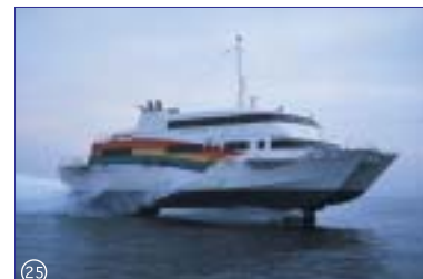
『レインボー』境港ー隠岐 双胴型全没翼型水中翼船(スーパーシャトル) [33.2m、38ノット]
