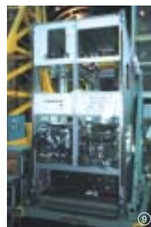
縦2m、横1mのアルミ製実験ラック。与圧部には合計10体が搭載され、なかには材料実験用温度勾配炉などが設置される。
