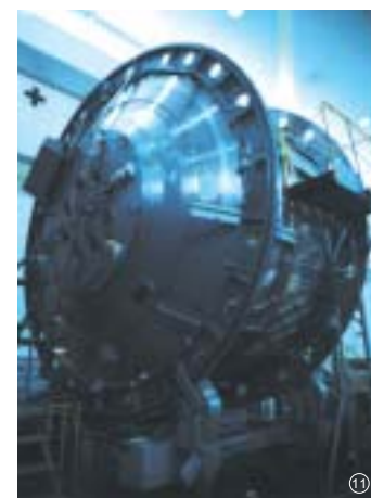
主構造の組み立てを終了した補給部と与圧区。アイソグリッド構造の壁面の外側にさらにアルミ製バンパーが付けられる。
