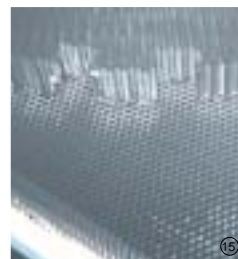
◀フェアリングに使われるハニカムコアは厚さ40mm。上にあるのはドア用のハニカムコア。スキン材との接着部には超音波検査が行われる。
