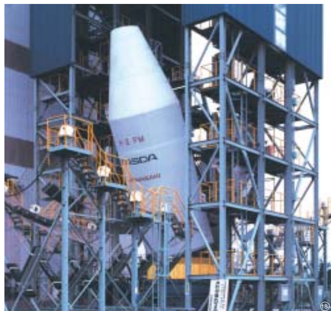
フェアリングの分離試験のようす。分離時中の人工衛星などを傷つけないように、フェアリングは2つにきれいに割れる必要がある。
