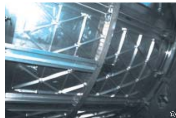
主構造の組み立てを終了した補給部と与圧区。アイソグリッド構造の壁面の外側にさらにアルミ製バンパーが付けられる。
