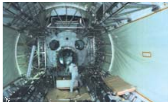
縦2m、横1mのアルミ製実験ラック。与圧部には合計10体が搭載され、なかには材料実験用温度勾配炉などが設置される。
