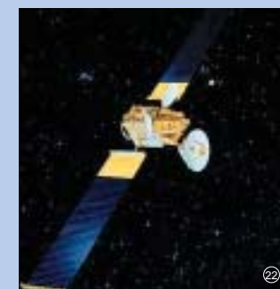
アルミ蒸着フィルムが取り付けられた人工衛星「かけはし」。金色に光って見えるのがフィルム部分で、ポリエステルやポリイミドなどが使われる。
