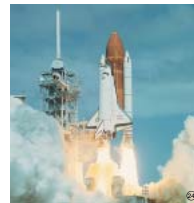
1998年のスペースシャトル「ディスカバリー」では、ロケット燃料タンクに初めてアルミ・リチウム合金が採用された。
