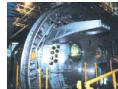
電気コネクタや各種バルブ、ガラス窓などが付けられる後方コーン。直径4mにも及ぶアルミ鍛造品を削り出して作られた。
