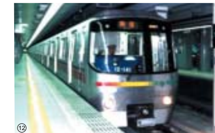
軽量化による省エネルギーを果し、耐久性にもすぐれたアルミ鉄道車両
