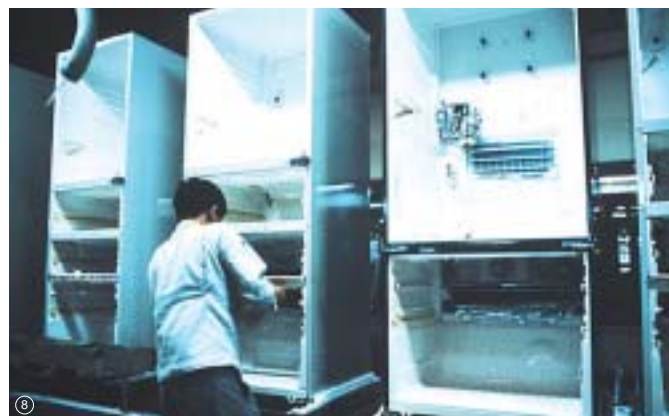
家庭用冷蔵庫の組立ライン(松下冷機・草津工場)。庫内の配管の多くは従来どおり銅管が使われている
