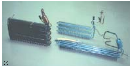
銅管(左)からアルミ管(右)への材料代替により、オールアルミ化した冷蔵庫エバポレータ。分解効率向上とともに、軽量化の効果もあった
