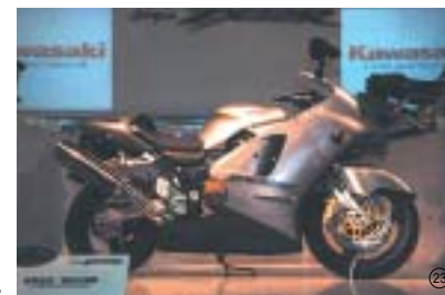
アルミ製新型フレーム、マグネシウム部品などを多く採用した「カワサキ・Ninja ZX 12R」。
