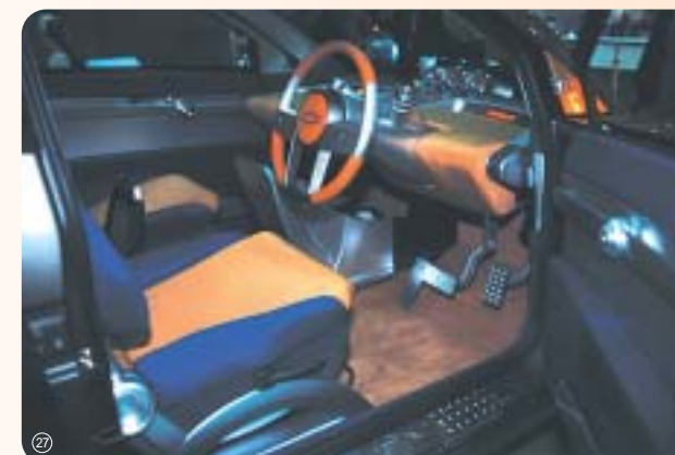
シート、ペダルなどインテリアにアルミを使用し先進性をアピールした「GM・トライアックス」。
