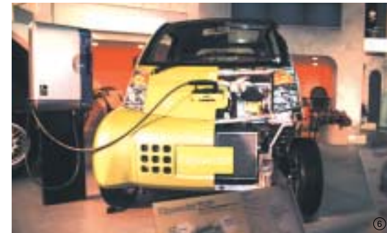
コンパクトでユニークなデザインの「日産・ハイパーミニ」は、アルミスペースフレームを採用。
