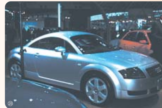
アルミスペースフレーム、アルミ製ボディパネルの「アウディ・TTクーペ」は今年から日本市場にも登場。
