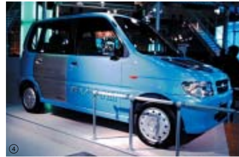
軽自動車のハイブリッド車「ダイハツ・MOVE EV-H」は、ボンネット、ルーフ、ドア、フェンダー、さらにブレーキ、ショックアブソーバ、ロアアーム、燃料タンクなどをアルミ化した。(協力:神戸製鋼グループ日本)
