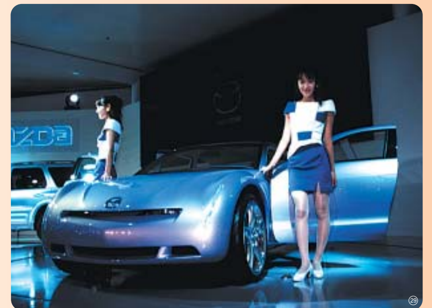
新世代ロータリースポーツの「マツダ・RX-EVOLVE」。ボンネットやサスペンションにアルミを採用したほか、ブレーキロータ、キャリバに高耐熱アルミ複合材を使用。
