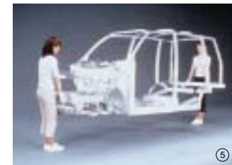
軽自動車のハイブリッド車「ダイハツ・MOVE EV-H」は、ボンネット、ルーフ、ドア、フェンダー、さらにブレーキ、ショックアブソーバ、ロアアーム、燃料タンクなどをアルミ化した。(協力:神戸製鋼グループ日本)
