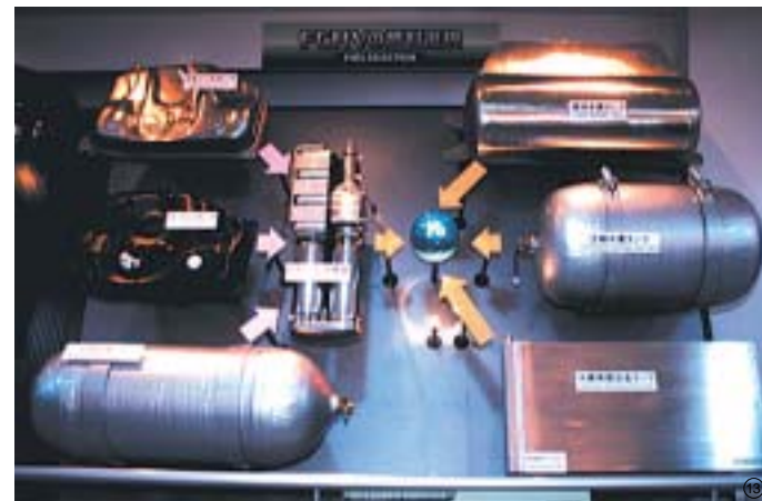
「トヨタ・FCHV」では燃料電池システムの中で天然ガスタンクや圧縮水素タンクに軽量の炭素繊維アルミ複合材を使用。
