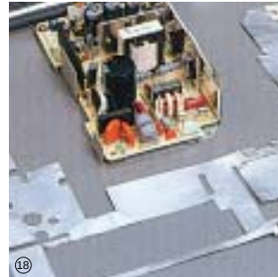
⑱ ファクシミリユニットに貼り付けられたシールド材
