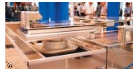
⑳ アームや搬送レールにアルミニウムが使われた搬送装置
