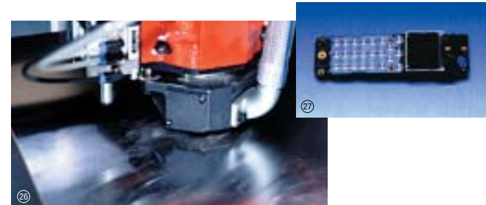
㉖ プリント基板のドリル孔あけに使われるアルミ製エントリーシート。ミクロンオーダーの孔位置精度を実現し、またドリリング時は200℃以上となる表面の放熱に効果がある。(写真は携帯電話用基板)
