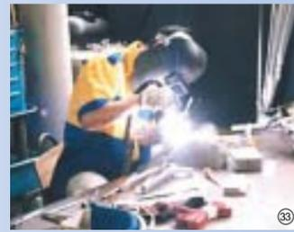
選手のオーダーに合わせてアルミ製フレームの溶接
