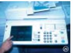
29 高齢者でも見やすい大型液晶パネルを採用するなど、随所に工夫が施されているデジタル複合機
