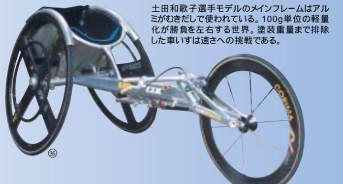
土田和歌子選手モデルのメインフレームはアルミがむきだして使われている。100g単位の軽量化が勝負を左右する世界。塗装重量まで排除した車いすは速さへの挑戦である。
