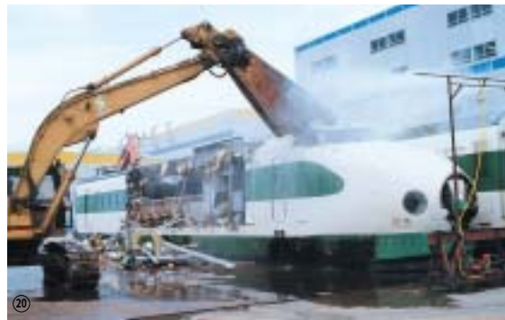
古くなった200系新幹線車両は解体され、材料ごとにリサイクルされている（JR東日本・仙台総合車両所）
