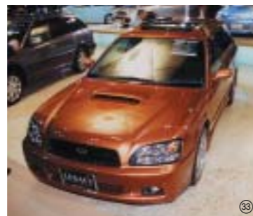
スバル「レガシー」ではフード、足回り部品がアルミ製
