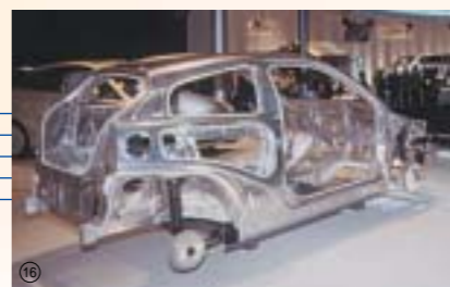
アルミスペースフレーム構造を採用するなど軽量化を追求し、世界最高レベルの超低燃費を実現したトヨタ「ES 3 」
