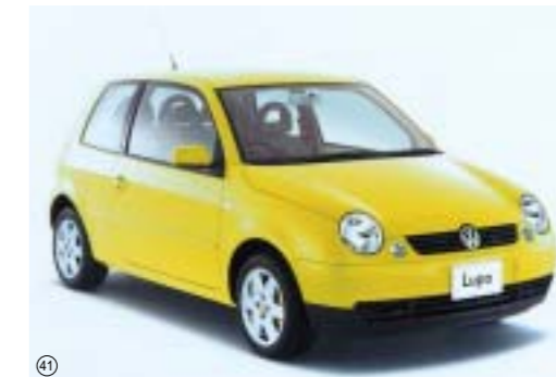
フォルクスワーゲン「ルポ」では、高性能アルミエンジンを搭載し、一部車種ではオールアルミボディを採用
