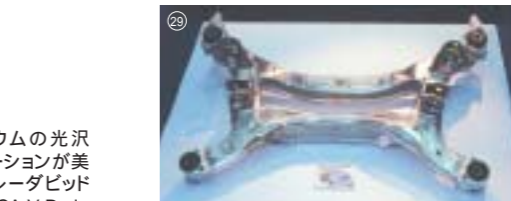
ハイドロフォーム成形技術を活用したアルミ製サブフレーム(ヨロズ)
