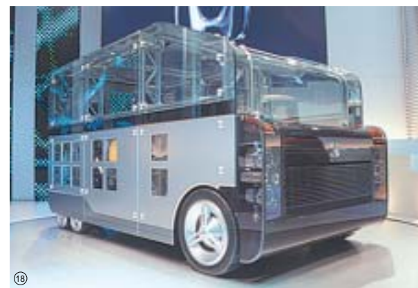
ホンダ「ユニボックス」はトラスとパネルの組み合わせで、パネルの着脱も容易
