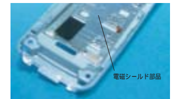
樹脂ベースにアルミ蒸着を施した電磁波シールド部品
