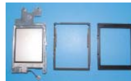
アルミダイカスト製の携帯電話用液晶ホルダー。強度、放熱性にすぐれ、マグネシウムに比べ薄肉化が図れる。リサイクルしやすいことから注目されている
