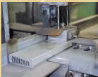
テンホールズ・ハーモニカの構造はカパー、リードプレート、ボディ(上写真中央)で構成される。とくに人気モデルのボディはアルミ押出材が切断され使用されている(下写真)。
