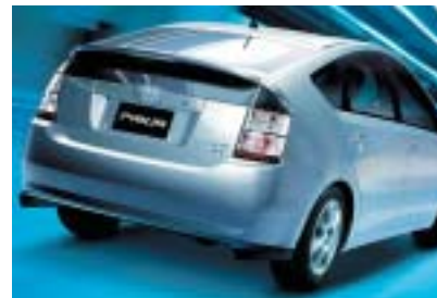
バックドアにアルミニウムを採用。軽量化によりステアリング性能向上を図っている
