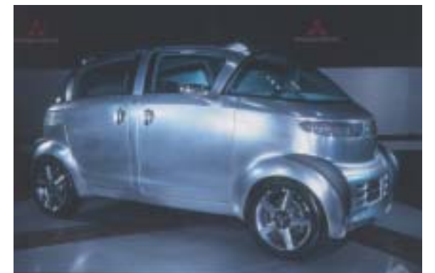
アルミ製ボディが印象的な「SE・RO」。サスペンションはリア、フロントともにアルミ部品を多用している
