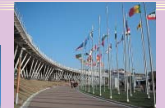
愛・地球広場には、参加国の国旗や国際機関の旗などが並び、ポールはすべてアルミ製(6000系合金(Al-Mg-Si系合金))。最近では旗ポールはほとんどがアルミ製となっており、すぐれた耐候性や軽量による高い施工性などが採用理由となっている。
