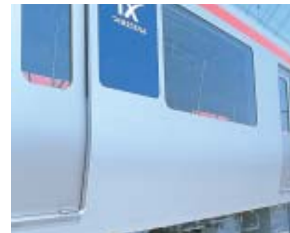
なめらかな曲面をしている車両側面。側面には7枚の押出材材が接合されているが、FSW技術で接合された側面を見ても、接合の跡はほとんどわからない。
