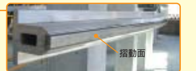
電気を供給する電車線。ステンレスで摺動面の強度を高めたアルミニウムが使用されている。(写真提供:愛知高速交通(株))
