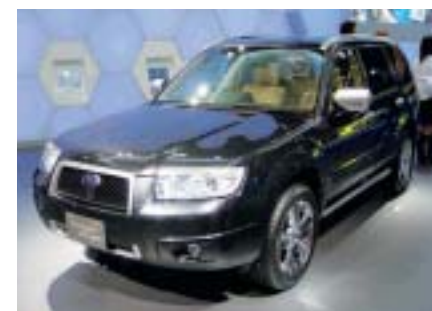
スバル「フォレスタ― Edge」style」は、フード、バンパービーム、ホイール等にアルミニウムを採用。
