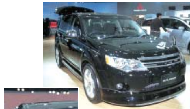
2005年10月に発売された三菱SUV「アウトランダー」。面積の大きいルーフにアルミニウムを採用。
