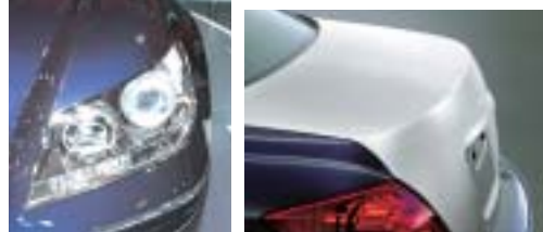
国産車で初めて最高出力300馬力のエンジンを搭載したホンダ「レジェンド」。凹凸の大きいフェンダー(写真左)とふくらみのあるトランクリッド(写真右)は、アルミ高速ブロー成形技術の採用により複雑な形状が可能となった。
