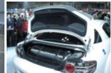
マツダの水素ロータリーエンジン車「RX-8ハイドロジェンRE」は、水素でもガソリンでも走行可能なデュアル燃料車。長距離移動や水素燃料供給施設がない地域への走行などに高い利便性を発揮する環境対応車となっている。フード、リアドア、フロントアッパー・ロアーム等にアルミニウムを採用。高圧水素タンクにはアルミライナーを使用している。
