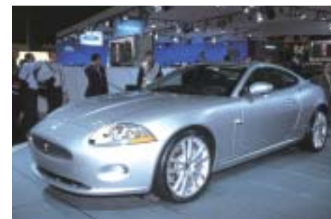
ジャガー参考出品車「NEW-XK」は、アルミモノコックボディで大幅な軽量化を実現している。
