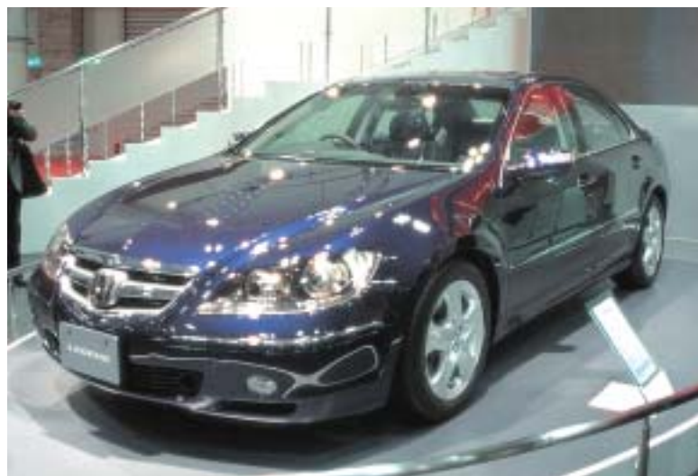
国産車で初めて最高出力300馬力のエンジンを搭載したホンダ「レジェンド」。凹凸の大きいフェンダー(写真左)とふくらみのあるトランクリッド(写真右)は、アルミ高速ブロー成形技術の採用により複雑な形状が可能となった。
