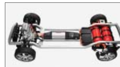
新方式の採用により、燃料電池をセンターに縦置きにし、低床化を実現した。
