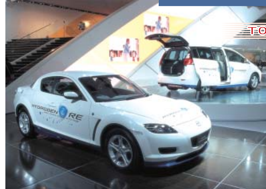
マツダの水素ロータリーエンジン車「RX-8ハイドロジェンRE」は、水素でもガソリンでも走行可能なデュアル燃料車。長距離移動や水素燃料供給施設がない地域への走行などに高い利便性を発揮する環境対応車となっている。フード、リアドア、フロントアッパー・ロアーム等にアルミニウムを採用。高圧水素タンクにはアルミライナーを使用している。
