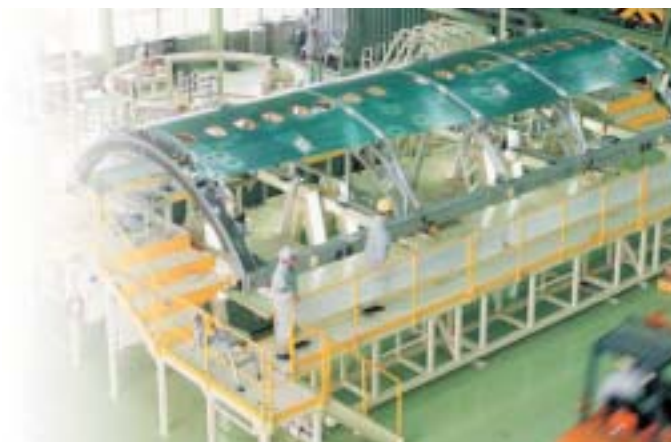
2枚あるいは3枚の胴体パネルを組み合せ、より大きなパネルにする。
