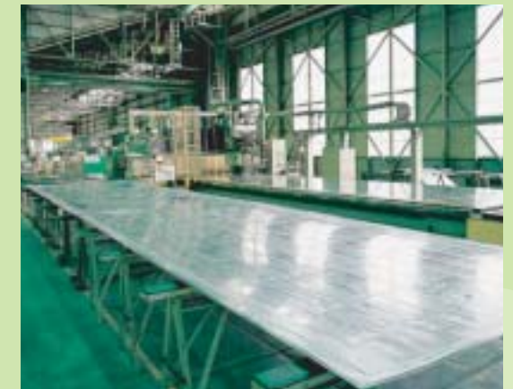
アルミ板は表面が磨き上げられ、ポリッシュドスキンと呼ばれる。
