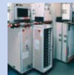
快適で機能的なラバトリーには、フレーム部にアルミ押出型材などが使用されている。
