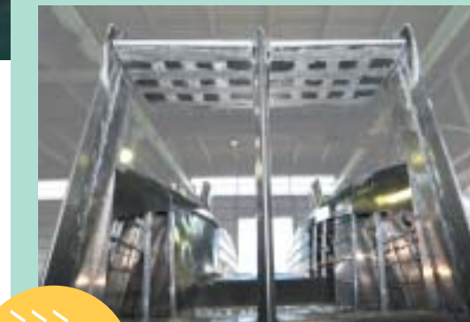
この部分が船の心臓となる。アルミ製の翼が波をとらえ推進力を生み出す
