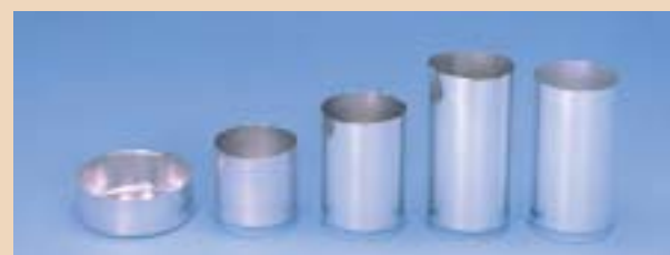
缶ボディの製造では、いちばん左の浅いカップから、側壁が徐々に伸ばされ缶の形ができていく
