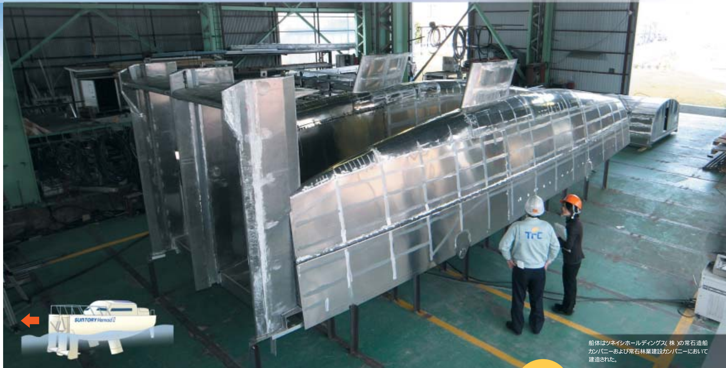
全長9.5mのオールアルミ製双胴船。写真は、建造中のため船底が上のさかさまとなっている。写真左が船の前方となり、2枚の翼が付いている。これが波を受けて推進力を発生させる。
