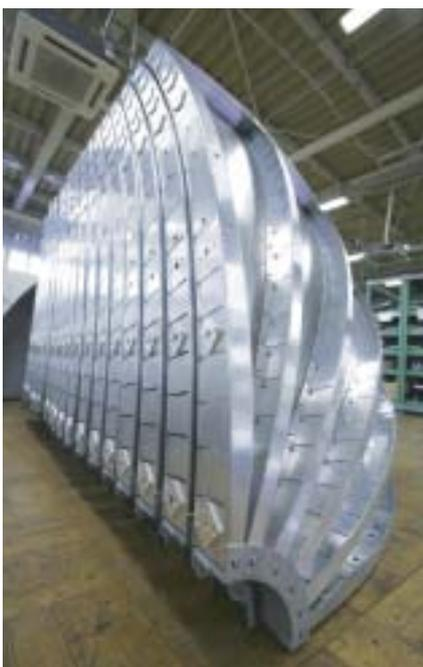
主反射鏡のスキンはもちろんのこと、補強材やリベットもアルミニウムが使用されている。副反射鏡、導波管などもアルミ製。A5052、A6063合金等が採用されている。
