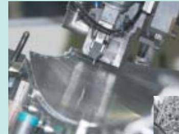
自動でリベットが打ち込まれる。もちろんリベットもアルミ製。主反射鏡1基で約1000本のリベットが使用される。
