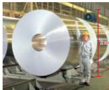
アルミニウム板を巻き取ったものをコイルと呼びます。大きいコイルは直径が2mにおよぶものもあります。このコイルを切断して板にしたり、細長く切り幅の狭い条にしたりして、その後さまざまな製品に加工されます。約1万mの薄板から、アルミ缶を約140万缶もつくることができます。
