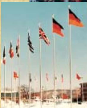
スウェーピング加工により、先端に行くほど細くなっている旗ポール
