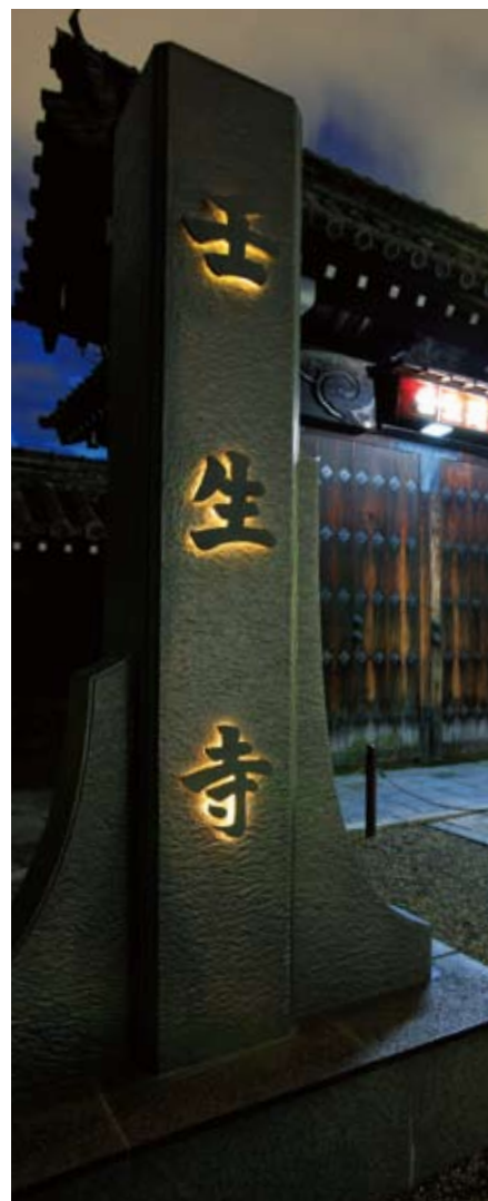
文字の裏側に埋め込んだ光ファイバーが点灯し、10秒ごとに5色に変わる
