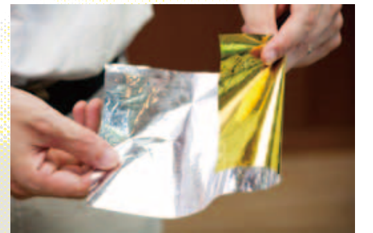
黄色く見えるのがポリミド本来の色味。反対側がアルミ蒸着した面。
