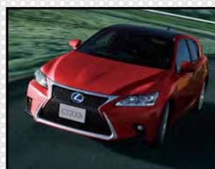
レクサスブランドの小型ハイブリッド車。フード、バックドアにアルミニウムを使用。 写真提供：LEXUS
