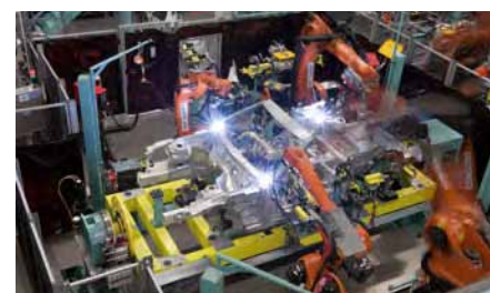
メルセデス・ベンツSLクラスのライン。アルミボディシエルの製造は誤差1mm未満という非常に高い寸法精度が要求される。 写真提供：Daimler AG
