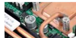
CPUに電力を供給する、円筒形の大容量アルミ電解コンデンサ。
