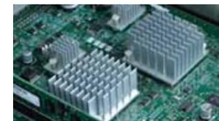
空冷のためのヒートシンクにはアルミニウムが使用されている。
