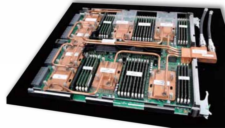
システムラックの中に入っているシステムボードには、4つのCPU(中央演算装置)、アルミ製のコンデンサやヒートシンクなどの部品がぎっしりと搭載されている。
