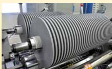
製品の幅に合わせてアルミ箔を裁断する。
