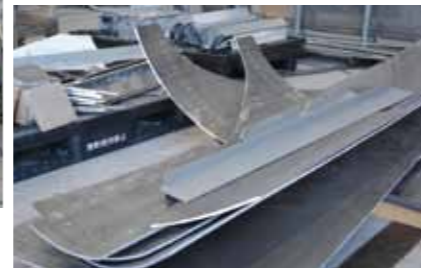
アルミ船に使われる5083アルミ合金板は、耐食性や加工性、溶接性にすぐれている。
