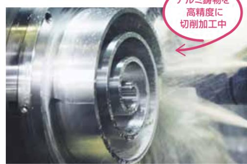
切削加工中のうずまき旋回体は空気圧縮機の主要部品
