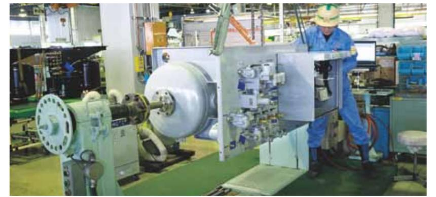
アルミ管座と空気タンクを一体化し、配管レスにしたブレーキ制御装置
