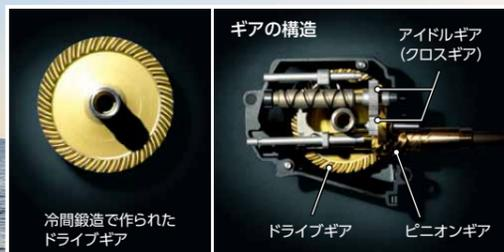
HAGANEギアには、ドライブギアに7075系合金、ボディにダイカストなどのアルミニウムが使われる。ドライブギアは、強度と寸法精度の高さ、軽量性、そしてボディでは強度に加えさびにくく、美しい光沢を得られることがアルミニウム採用の理由だ。
