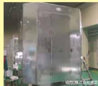
インナーシールドの壁材はアルミニウムが使用されている。
