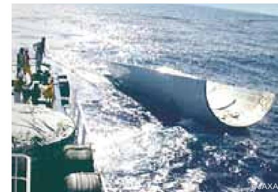
H-IIAロケットのフェアリングは比重が小さく、落下した後は海に浮いており、これを船で回収している。イプシロンロケットでは、フェアリングパネルのハニカムコアに溝を付け、パネル内に海水が流れ込むように工夫されている。パネルは海中に沈むので、船舶の航行の妨げにならない。
