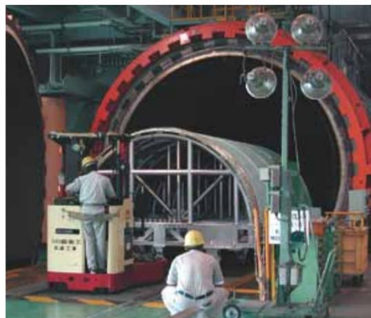
オートクレープは、大型のパネル材料を積層し、焼き固める設備。大きなパネルをそのまま入れられる大きさが必要であり、材料をムラなく均一に硬化して、十分な強度が確保できるように設計されている。
