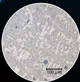
アルミニウム－ケイ素合金において、溶湯の冷却が速いとき、固まり始めは合金に含まれるケイ素が細かい結晶粒となる。
