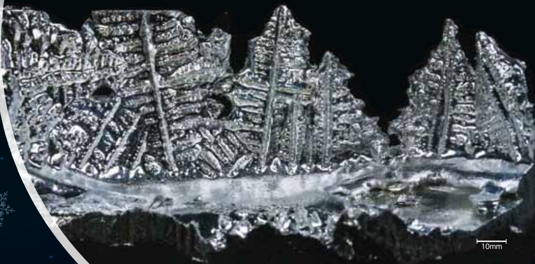
高純度アルミニウムの樹枝状結晶(デンドライト)。まるで雪の結晶のよう。
