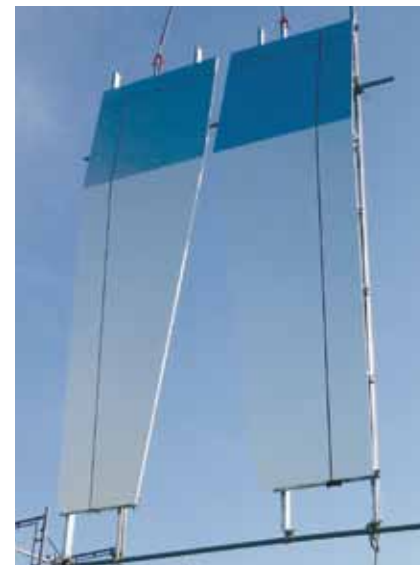
鏡面アルミパネルの輝度をモックアップで確認
