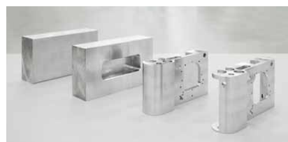
アルミニウムの塊から削り出されていくボディ。
