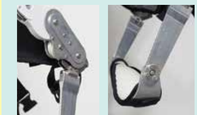
プーリー 腿パッド プーリー(滑車)部分や腿パッドもアルミ製。腿を固定するパッドは重要であり、これを外すと補助力が無くなり、物を持ち上げることができなくなる。
