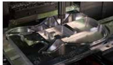
切削されたボディは、ヘアライン処理を経てアルマイト加工が施される。ネックやピックアップなどのパーツの組み込みも含めすべて国内で製造。高度な技術が要求される。
