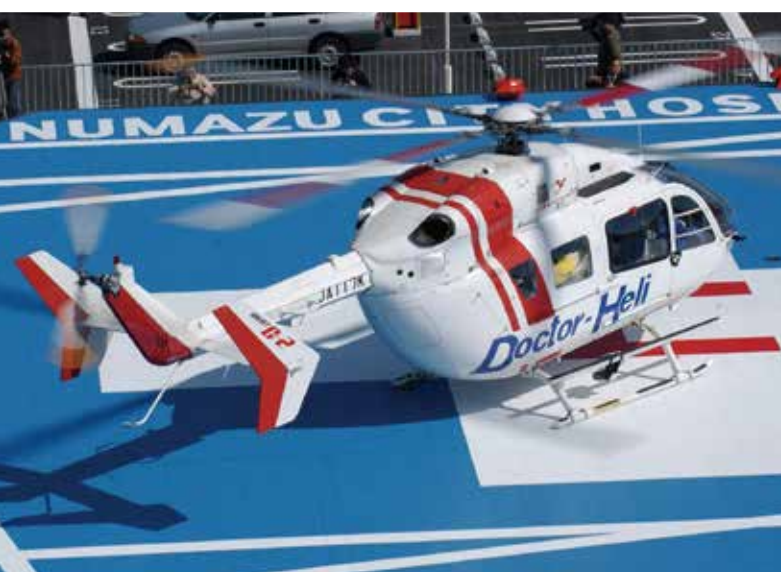
ドクターヘリは公園や学校の校庭に緊急着陸することもあるので、子ども達を巻き込まないように、テールローター(尾回転部分)の位置は高めになっている。
