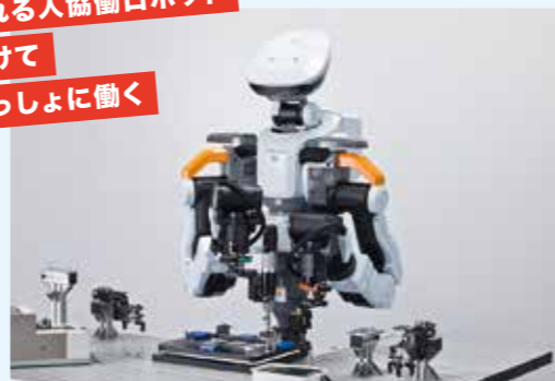
人協働ロボットは、人間を助けて、同じ生産ライン内で作業するもので、人と人の距離を開けることもでき、今後の普及が期待されています。(写真はカワダロボティクス(株)「NEXTAGE」)
