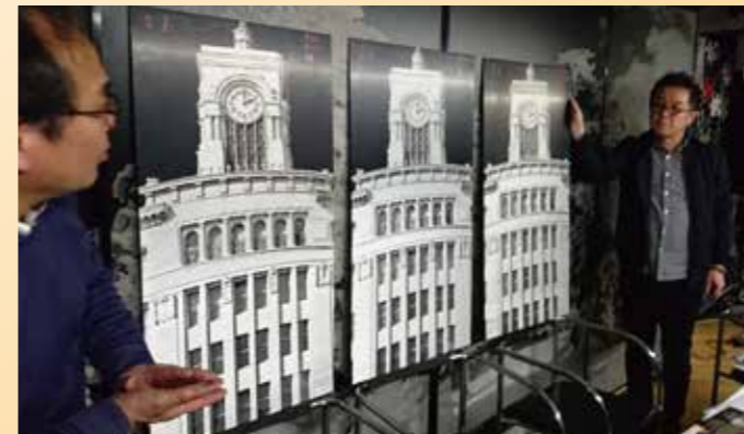
厚さ3mmのアルミ板の基本サイズは縦1,600mm×横1,200mm。黒色アルマイトの後、表面に銀色の線を切削加工し、透明なアルマイトを施す。切削後にバリが残らず、仕上がりの光沢が美しい1100アルミ合金が使われている。
