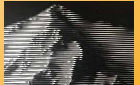
切削加工のサンプル例(拡大写真)。先端が回転する切削工具を使い、アルミ板の表面に等間隔(ピッチ)のV型の溝を削っていく。切削の深さを調整することにより溝の幅が変化し、銀色に反射する線の調子を変えることができる。線の粗密によって、画像には濃淡のコントラストが生まれ、立体的な仕上がりとなる。
