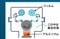
水引には、アルミ箔(厚さ10μm 程度)やアルミ蒸着フィルムなどが使われる。蒸着とは、真空装置 内で高純度の金属を蒸発させ、 フィルムの表面に膜を作る技術。 アルミ蒸着フィルムは包装材や ファッション素材などに広く使われている。
