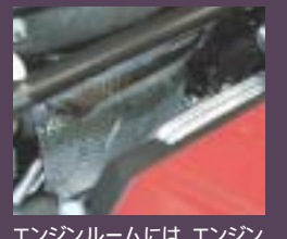
エンジンルームには、エンジンから出る熱を防ぐアルミ遮熱板が取り付けられている。
