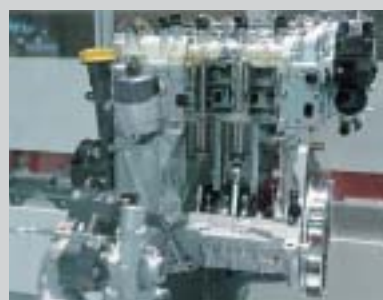
CO 2 排出が少ないディーゼルエンジンは、今後日本でも本格投入が期待される。エンジンシリンダブロックベースなどにアルミ部品を採用したスズキ「D13Aディーゼルエンジン」。
