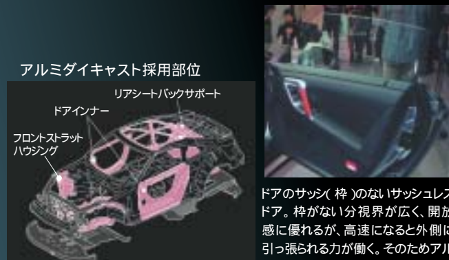
ダイキャスト材には、柔らかく伸びにすぐれたアルミ合金が使用された。これによって衝撃を吸収する機能を部材に付与している。
