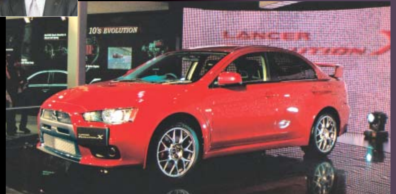
独特の逆スラントノーズデザインを採用。アルミ押出型材を使用したバンパーの下には、フロントグリルの内側にアルミ製インタークーラが見える。
