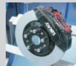
ブレーキキャリバのボディと内部のピストンをアルミ化することにより、大幅な軽量化を実現している。(アドビックス)
