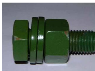
(a) 錆発生状態
