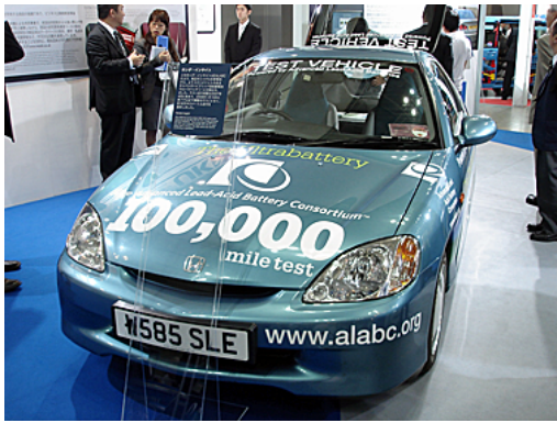
写真3 キャパシタ一体型鉛2次電池搭載車 (欧州先進鉛蓄電池開発組合)
