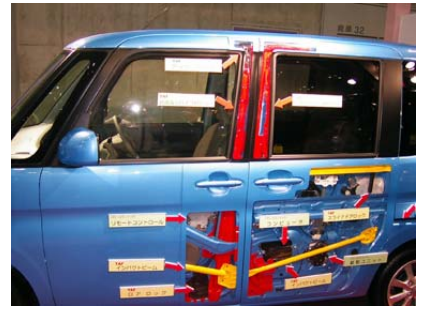
写真24 超高張力鋼管部材 (ダイハツ)
