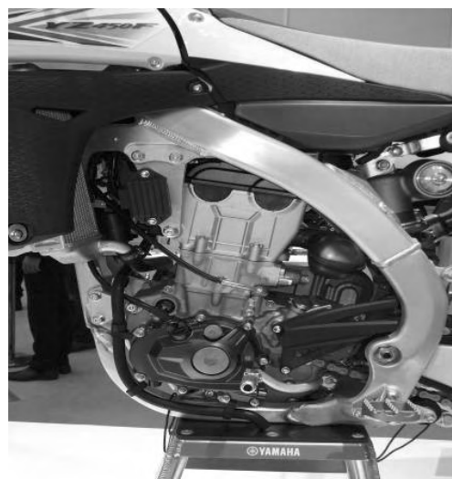
写真 17 ヤマハ YZ450F バイラテラルビームフレーム
