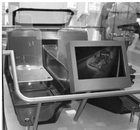
写真28 炭素繊維強化樹脂製一体フロア(豊田自動織機)
