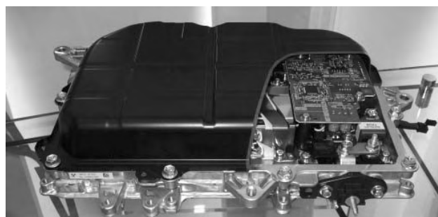
写真 22 DC-DC コンバータ（豊田自動織機）
