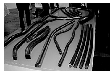
写真21 スペースフレーム部材 (住友金属/安川電機)
