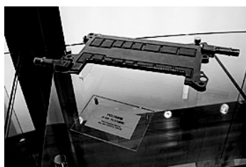
写真8 PCU冷却器 (豊田自動織機)
