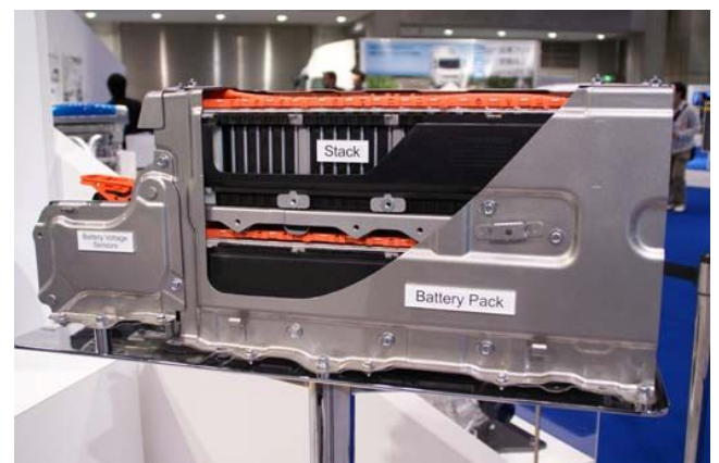
写真 54 プリウスαのバッテリーシステム
