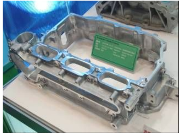
写真 42 コンデンサーケース (アーレスティ)
