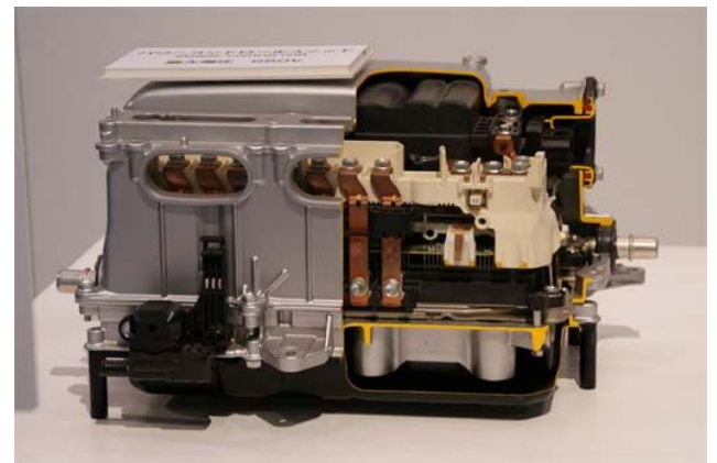
写真 53 プリウスのパワーコントロールユニット
