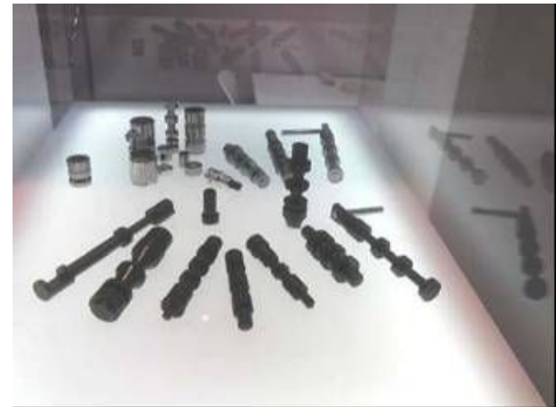
写真 48 アルミ製バルブスプール (GMB)
