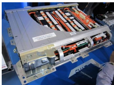
写真4 リチウムイオンバッテリー アルミフレーム (トヨタ自動車)
