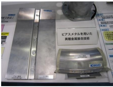
写真7 ピエスメタルを用いた異種金属接合技術 (神戸製鋼所)
