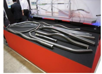
写真 18 3次元熱間曲げ焼入れ (住友金属工業)
