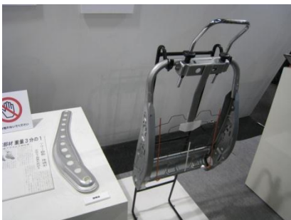
写真 13 座席フレーム (大成プラス、三井化学)
