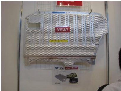
写真 10 高電圧バッテリー パワーエレクトロニクス類カバー (深井製作所)
