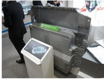
写真 5 アルミバッテリーケース (日立金属)
