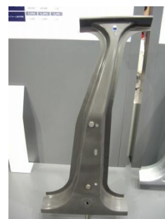
写真 25 ティラードテンパリング (局所焼入れ) B ピラー (ティッセン・クルップ・スチール)
