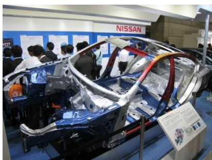
写真 23 1.2GPa 級高成形性超ハイテン材 (日産自動車)
