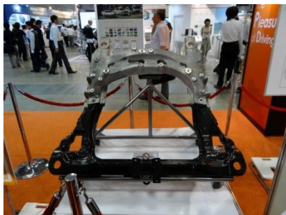
写真 19 スチール-アルミハイブリッドサブフレーム (本田技研工業)
