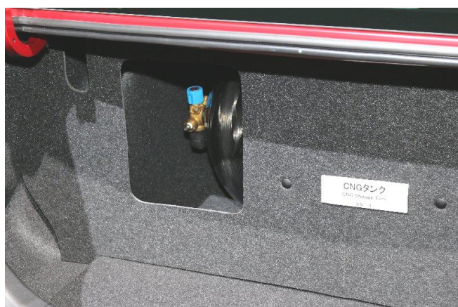
写真20 MAZDA 3 SKYACTIVE-CNG CONCEPTに搭載された高圧CNGタンク
