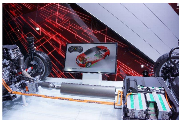
写真 2 3 A3 e-tron の動力機構説明モデル
