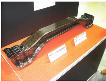
写真26 リアバンパービーム (サンワトレーディング)
