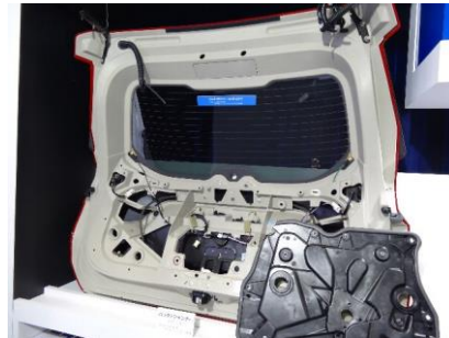
写真18 バックドアインナー (プライムポリマー/三井化学グループ)
