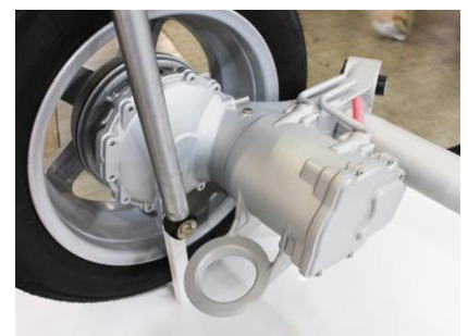
写真6 エレクトリックツイストビーム (開発品) (ゼット・エフ・ジャパン)
