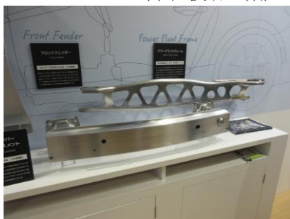
写真11 フロントバンパー レ インフォースメント (下) パワープラントフレーム (上) (UAC J)
